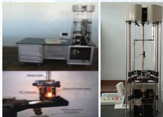
Fig. 58. Echipament pentru obtinerea de microfilament din topitura de aliaje
