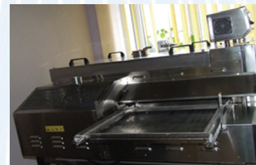
Aparat de uscare-termofixare-condensare-vaporizare (model TFO/S 500 mm) pentru operatii intermediare si finale de finisare superioara
