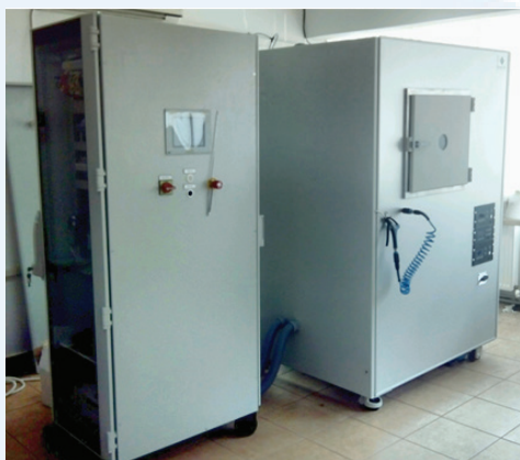
Fig. 70. Instalatie de plasma tip 400 CD roll-to-roll (Firma producatoare Europlasma din Belgia)
