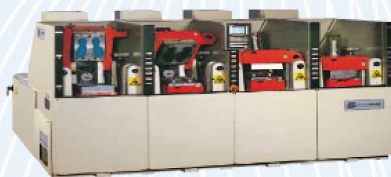
Fig. 71. Masina injectie ORCA bicolor (Firma producatoare Main Group din Italia)
