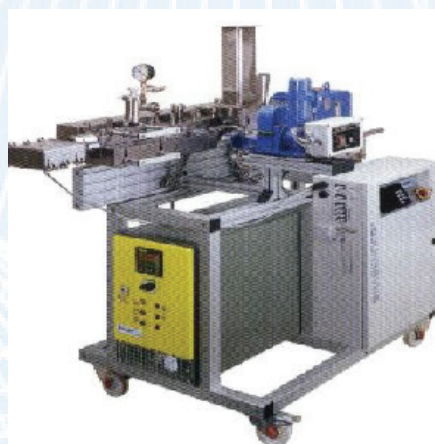
Fig. 60. Extruderul cu snec dublu, TSE35
