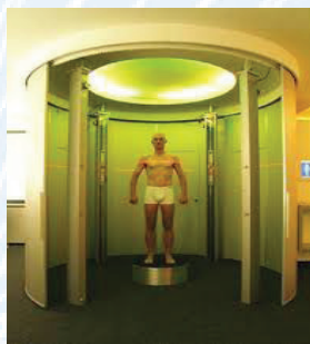
Fig. 69. Sistem mobil de masurare 3D automata a corpului (Firma producatoare Human Solutions GmbH din Germania)
