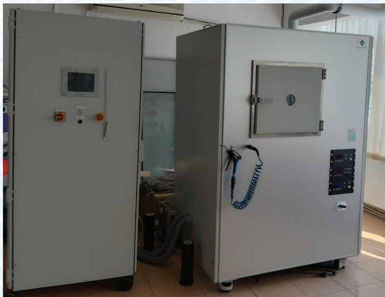
Fig. 54. Instalatie de plasma tip 400 CD Roll-to-roll (Furnizor Europlasma Belgia)
