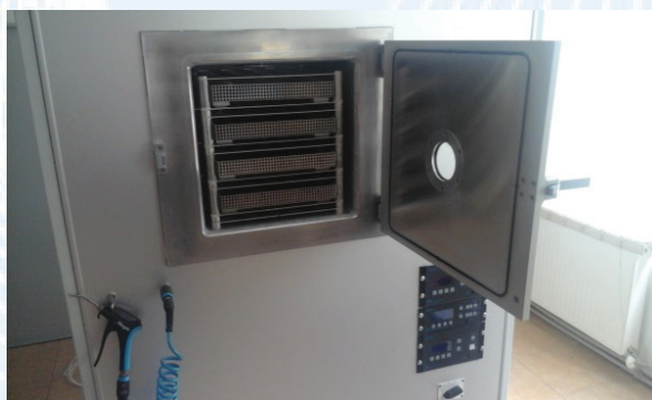
Fig. 55. Incinta de vidare de la instalatia de plasma
