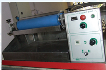
Fulard cu doua valturi oscilante vertical/orizantal (model BVHP 500/100) pentru impregnarea materialelor textile cu substante polimerice si de functionalizare
